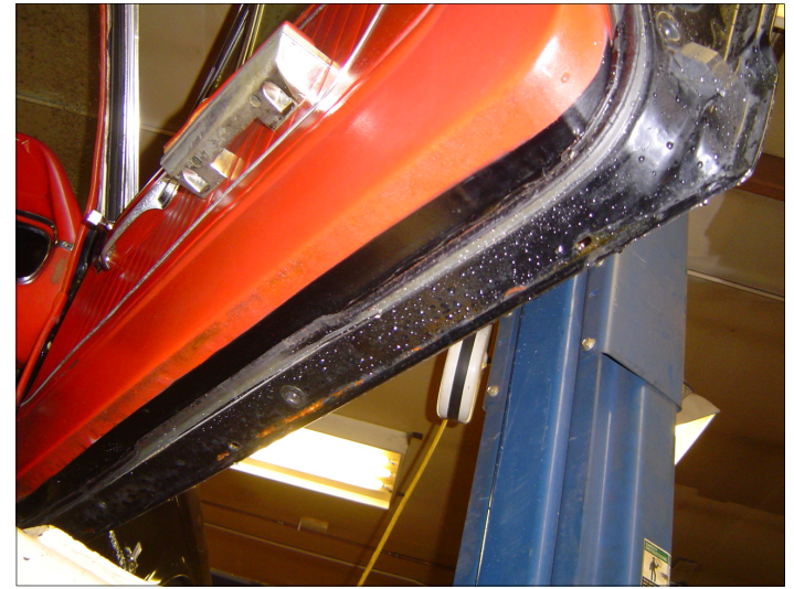
Bottom door edge paint break
